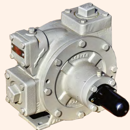
Средние дифференциальные роторные насосы Z2000 фирмы Corken относятся к семейству насосов серии Z, специально разработанных для работы с СУГ. Они отличаются надежностью и низким уровнем эксплуатационных затрат, хорошо зарекомендовали себя при эксплуатации в составе ГНС и автомобилей-газозов. Диапазон рабочих скоростей – 420...800 мин -1 , максимальное дифференциальное давление – 10,5 бар.
