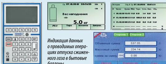
Индикация данных о проводимых операциях отпуска сжиженного газа в бытовые баллоны
