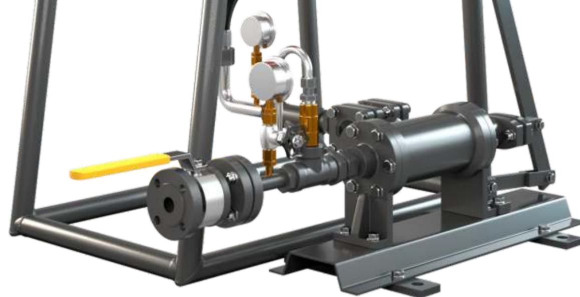
Оборудована пневматическим насосом для опорожнения жидкой и паровой фазы, клапаном и шлангом для присоединения баллонов.
