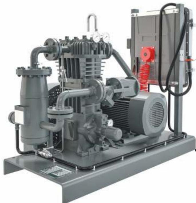
Комплектные поршневые компрессорные агрегаты сухого хода используются для перекачивания пропан-бутановых смесей и аммиака из корабельных танкеров, ж/д цистерн или автомобильных газовозов, а также последующей дегазации последних.
